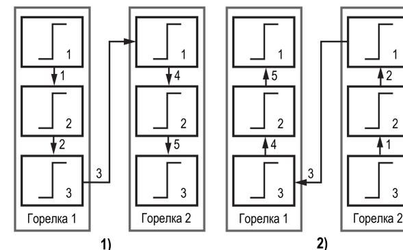
Рисунок 10.5 – Регулирование температуры по «1212»: 1) включение, 2) выключение
