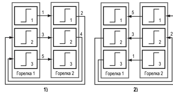
Рисунок 10.4 – Регулирование температуры по «1122»: 1) включение, 2) выключение
