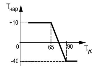
Рисунок 10.10 – График зависимости температуры уставки от наружной температуры
