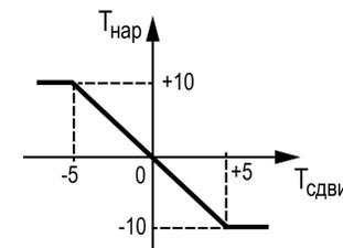
Рисунок 10.9 – График зависимости температуры сдвига от наружной температуры
