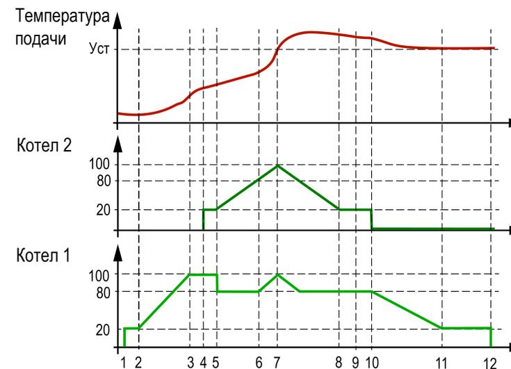
Рисунок 10.6 – Работа каскада котлов с модулируемыми горелками
