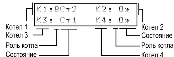
Рисунок 10.11 – Отображение ролей котлов на индикаторе
