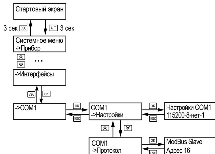
Рисунок 12.1 – Настройка параметров сетевого интерфейса
