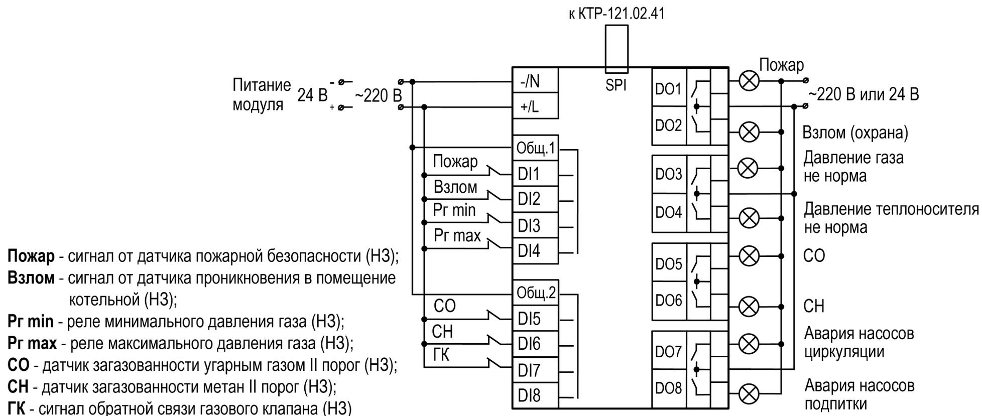
Рисунок 7.5 – Схема подключения к ПРМ-1 сигналов общекотельных аварий
