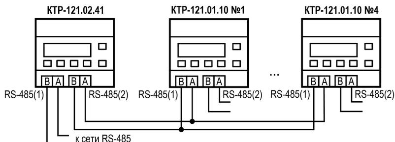
Рисунок 5.1 – Соединение каскадного регулятора с котловыми
